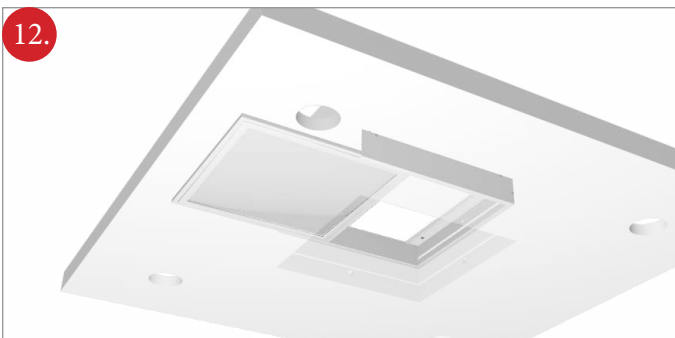
Az álmennyezet sziget ezen célra kialakított fiókján keresztül csúsztatjuk be a keretbe a LED panelt
